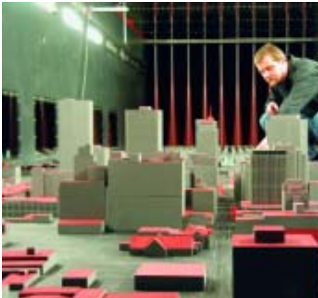
Blick in den Grenzschichtwindkanal. Zu sehen ist das Modell der Innenstadt von Oklahoma City. Dort wurde im Juli 2003 unter Beteiligung des ZMK das weltweit bisher größte Ausbreitungsexperiment in einem Stadtgebiet durchgeführt.
