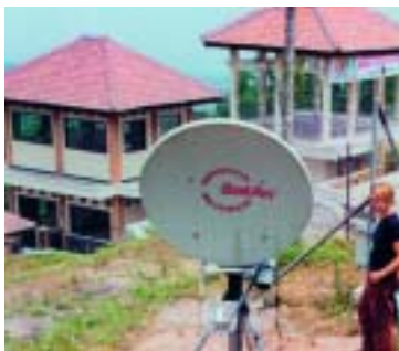
Aufbau eines Doppler-Radarsystems am Vulkan Merapi, Indonesien, zur Beobachtung vulkanischer Aktivität. Das Gerät wurde als Regenradar im Meteorologischen Institut der Universität Hamburg entwickelt und für geophysikalisch/vulkanologische Fragestellungen umgebaut.
